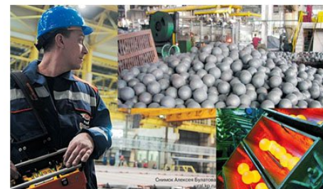
завод «Нейвасталь» производство стальных мелющих шаров
