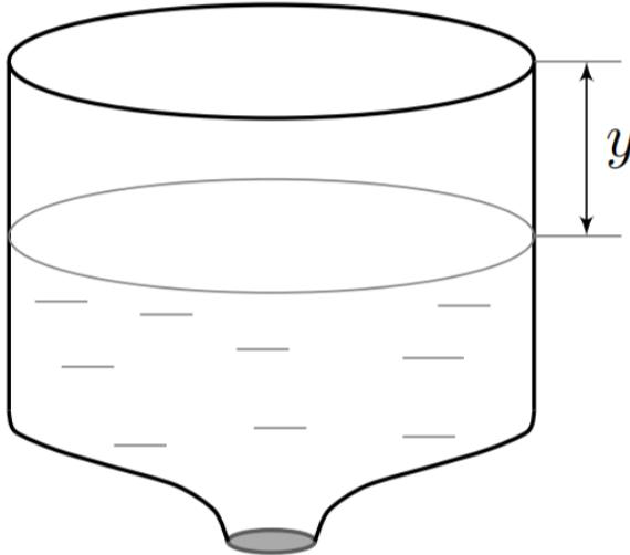
Внутренний объем  $V_{\text{вн}} = V_{\text{воды}} + S_{\text{вн}}y = 56,0$  мл. Эталонный объем на авторской установке (измеренный напрямую) 57 мл.
