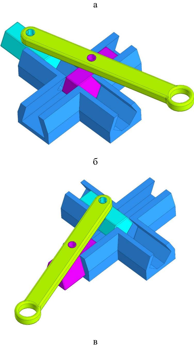
Рис. 1. «Эллипсограф Архимеда»: *а* – основные элементы эллипсографа; *б, в* – демонстрация перемещения членоков в пределах цилиндров основания при перемещении стержня
