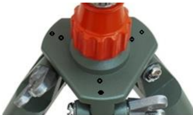
Трегер – основание теодолита
