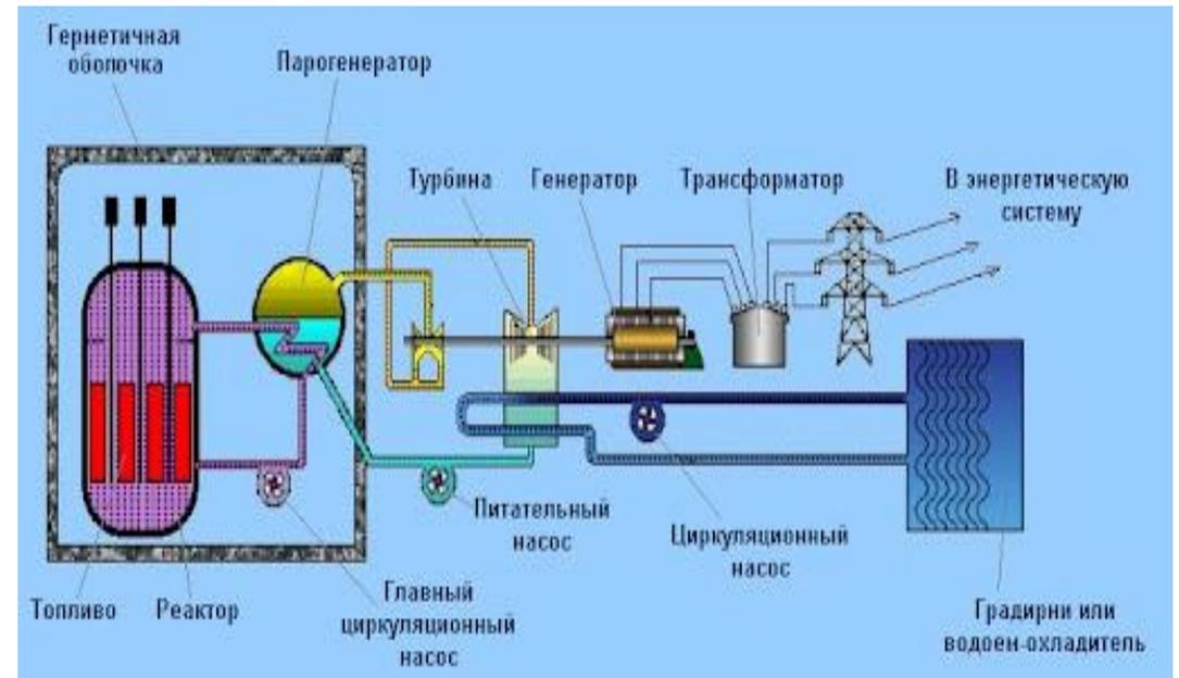
На рисунке показана схема атомной электростанции. Отличительной особенностью атомных электростанций является наличие атомного реактора.
