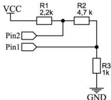
Рис. 8. Принципиальная схема устройства.
