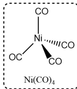
Количество  $CO$  в карбониле никеля можно определить с помощью правила 18 электронов: никель в степени окисления 0 имеет 10 электронов, для заполнения оболочки инертного газа ему не хватает 8 электронов, которые он может взять из 4 молекул  $CO$ .
