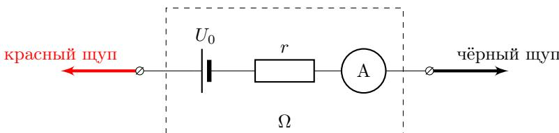
При подключении к омметру исследуемого резистора показания амперметра автоматически пересчитываются так, что на табло прибора отображается значение сопротивления исследуемого резистора  $R_x$ , подключённого к омметру.
