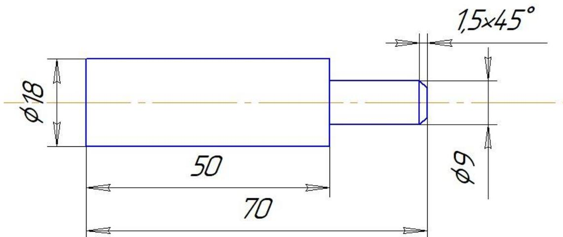
Рис. 1. Чертеж «Элемент петли»
