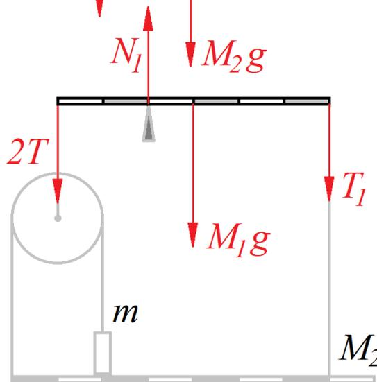
Так как блок имеет пренебрежимо малую массу и трение отсутствует, то сила натяжения верхней нити в два раза больше силы натяжения нити, перекинутой через него, то есть равна  $2T$ .
