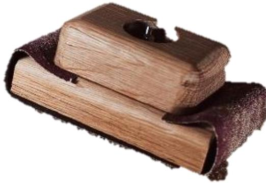
Рисунок 1 «Приспособление для полировки с удобной ручкой (без сборки на винте)»
