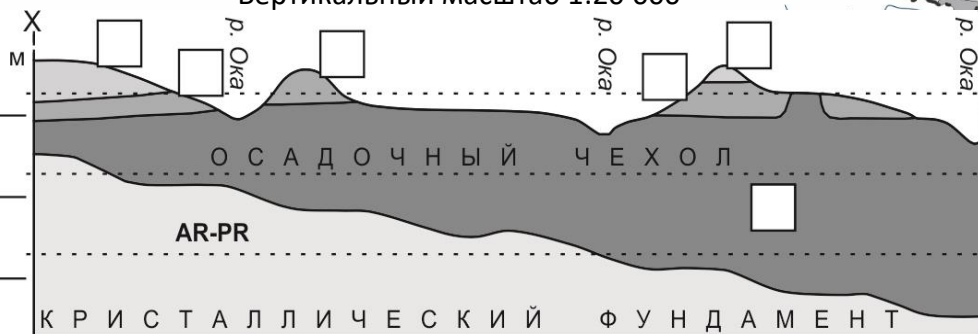
Геологический разрез по линии X-Y Горизонтальный масштаб 1:1 000 000 Вертикальный масштаб 1:20 000
