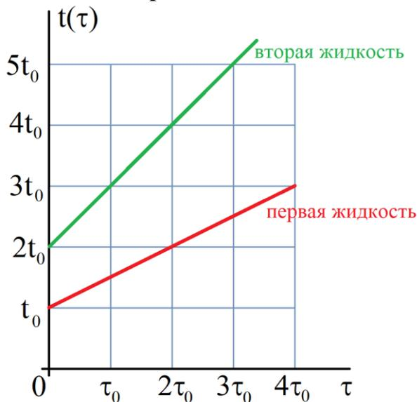
В сосуд с теплопроницаемыми стенками и вмонтированным нагревателем поместили жидкость некоторой массы и стали ее нагревать. График зависимости температуры от времени приведен на рисунке. Затем, вылив первую жидкость, в сосуд поместили такую же массу второй жидкости с другой начальной температурой и также сняли зависимость ее температуры от времени. Этот график также приведен на рисунке. Используя данные, определите отношение удельных теплоёмкостей этих жидкостей.
