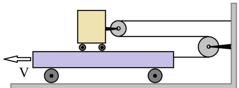
нитью, один конец которой привязан к ней, а второй к неподвижной стенке (см. рисунок справа). Большая тележка равномерно движется влево со скоростью  $V$ .
