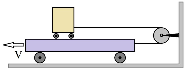
движется влево со скоростью  $V$ . Определить скорость малой тележки относительно земли и относительно наблюдателя, стоящего на большой тележке.
